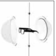
Zweischaliges Gehäuse Two-shelled housing
